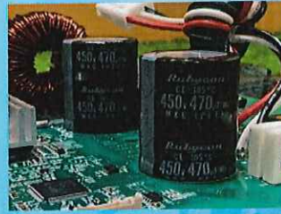
日本製電容器 (ルビコン) 保持穩定的電壓，使壓縮機效率提升
