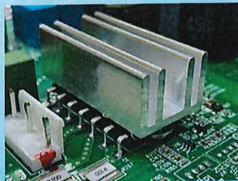
室外機馬達驅動IC外移 將馬達驅動IC移至基板上，能大 幅降低室外風扇馬達溫度及馬達 故障的情形。
