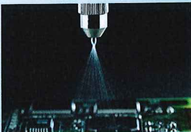
室內、外機變頻基板均塗佈 德國軍規等級之三防漆(防水、 防蟲、防靜電)作正反面塗佈， 壽命為一般塗佈漆的5~10倍。
